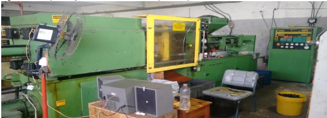
Figura 4 - Máquina Injetora Oriente Utilizada pela Empresa
